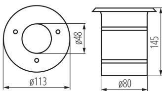
Грунтовые светильники Kanlux BERG – это светильник со сменным источником света GU10. Идеально подходит для подсветки проездов, аллей, тротуаров и т. д. Изготовлен из материалов высочайшего качества, благодаря чему устойчив к давлению до 2 тонн. Ударопрочность IK 08 и влагозащита IP 67 делают такой светильник максимально адаптированным к высоким нагрузкам в грунте.
